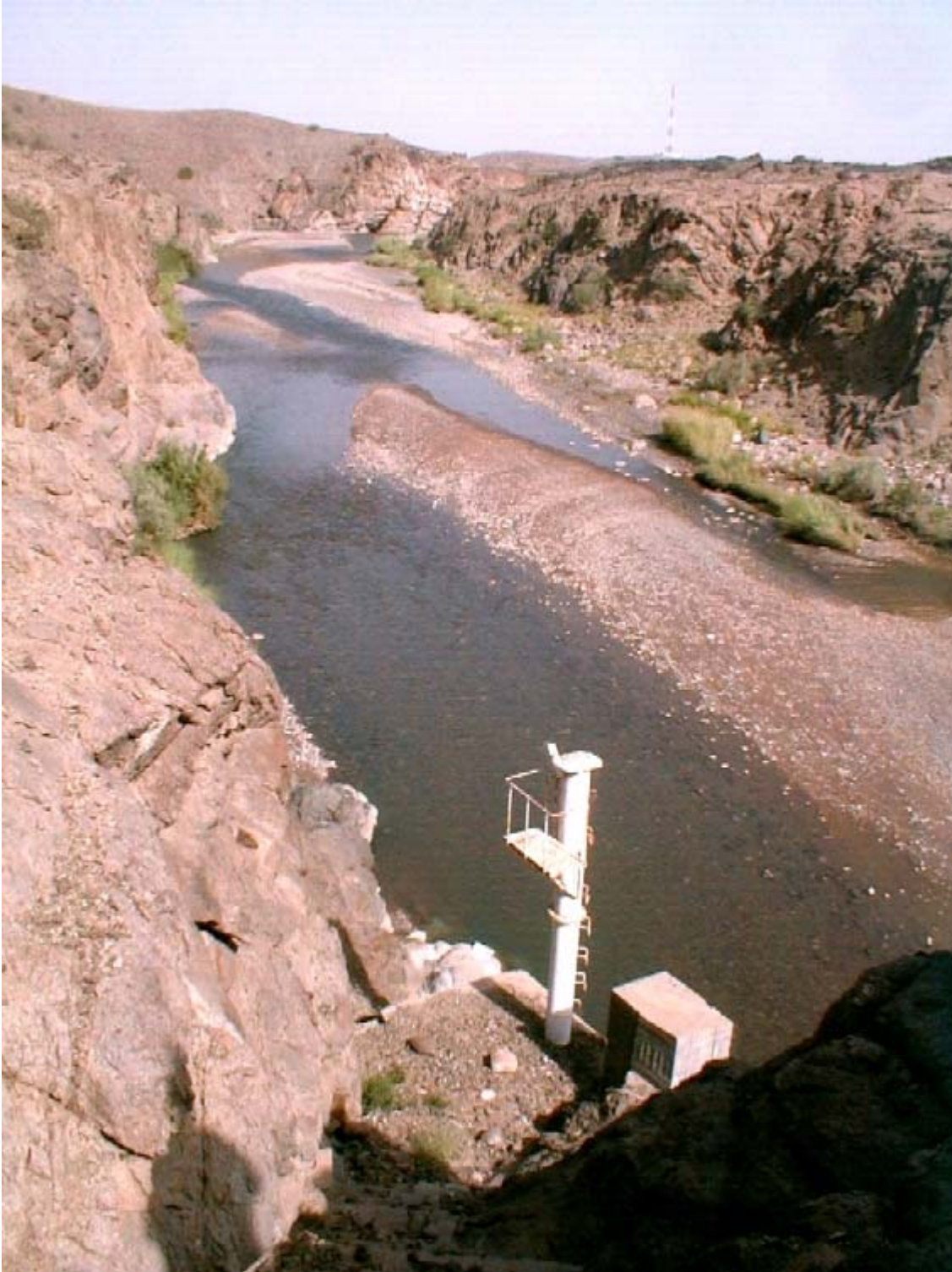
صورة : 46 محطة قياس تدفق السيول بوادي تين قبل حادثه سرقتها (تعود تبعيتها لهيئة الموارد المائية)
